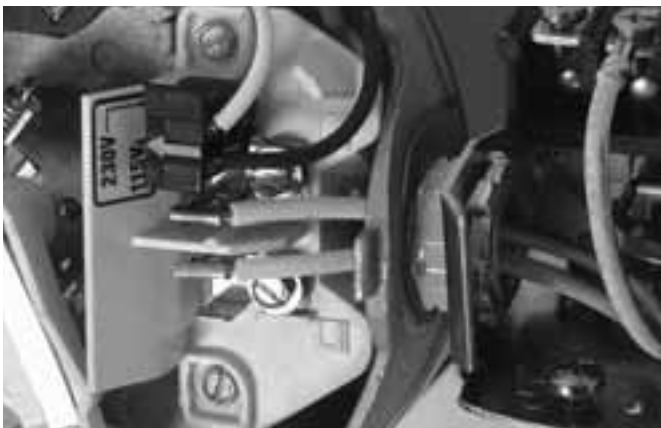
Figura 9: Tensión configurada para 115 voltios, tipo ficha.
