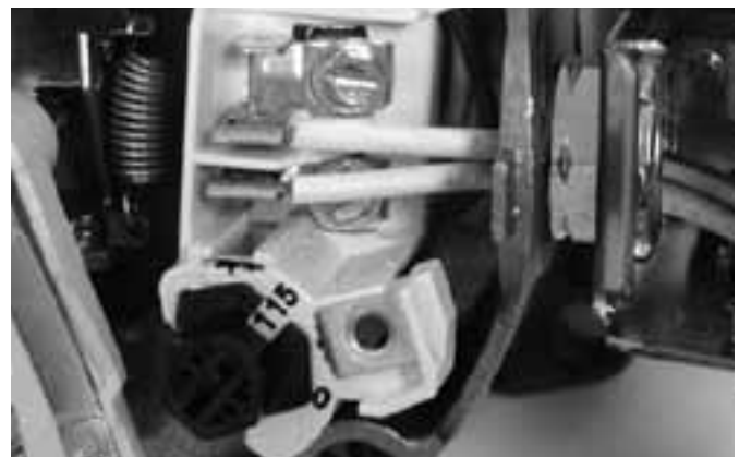
Figura 11: Tensión configurada para 115 voltios, tipo cuadrante.
