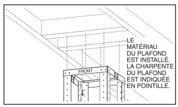
2. Une fois la surface du plafond finie, aligner le cadre de la hotte sur la charpente du plafond et le fixer avec six (6) vis de 4 mm x 38 mm. Serrer fermement en vous assurant que le cadre supérieur est solidement appuyé contre le plafond.
