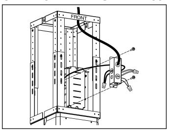
Retirer le couvercle du boîtier de câblage et effectuer les connexions entre le câble d'alimentation domestique et la hotte: le fil NOIR avec le NOIR, le BLANC avec le BLANC et le VERT avec le VERT. Remettre en place le couvercle.
