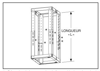
Déterminer la longueur « L » de l'ensemble de cadre selon la hauteur d'installation souhaitée. (Voir le tableau ci-dessous.) Pour régler la hauteur du cadre, enlever les huit (8) vis, glisser la section supérieure à la hauteur voulue, replacer et serrer les vis fermement.
