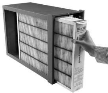
Fig. 18: cerciórese de que las flechas del filtro estén orientadas en la misma dirección que la flecha en el módulo de mejoramiento. Esto deberá estar en la misma dirección del flujo de aire.
