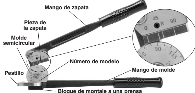
Figura 2 – Dobladora de la serie 400 para plomería
